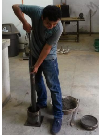
Figura 9. Caída libre del martillo para la compactación.
