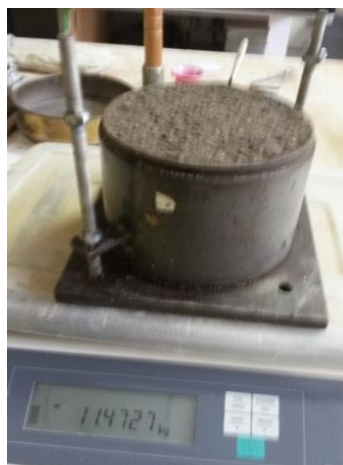
Figura 10. Molde con el material compactado y enrazado.
