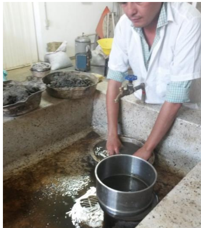
Figura 4. Lavado del material por el tamiz No 200.
