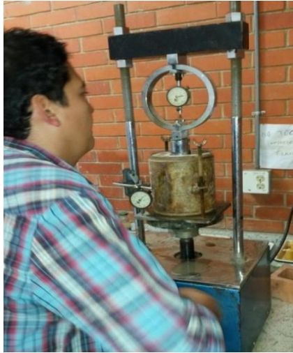
Figura 13. Penetración del material
