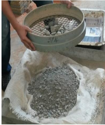
Figura 7. Tamizado por el 3/4"
