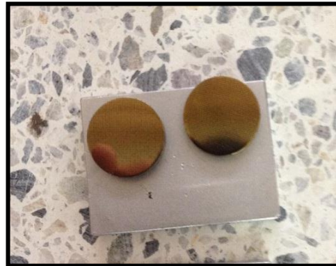
Figura 11: Superficie de la muestra de Ti6Al4V con tratamiento térmico a 400°C.
