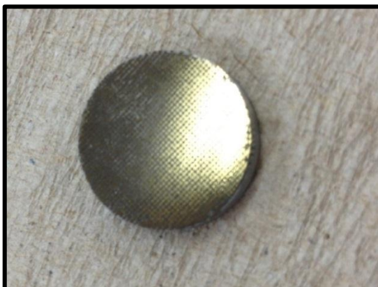
Figura 12: Superficie de Ti6AL4V oxidada térmicamente a 400°C y patronada por impresión láser indirecta.
