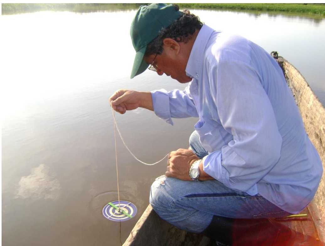
Figura 9. Medición de la zona fótica con el disco secchi.
