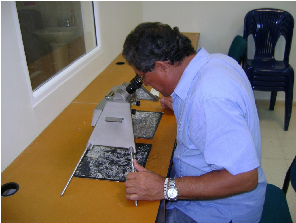
Figura 22. Medición del espejo de agua a través del estereoscopio de espejo.
