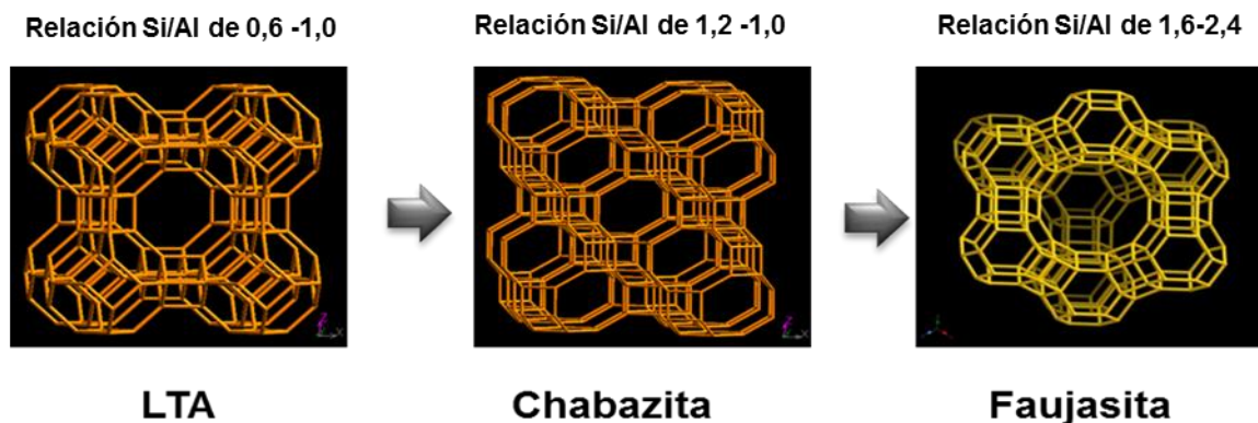
Figura 20. Transición de fases de zeolita LTA a Chabazita y Faujasita
