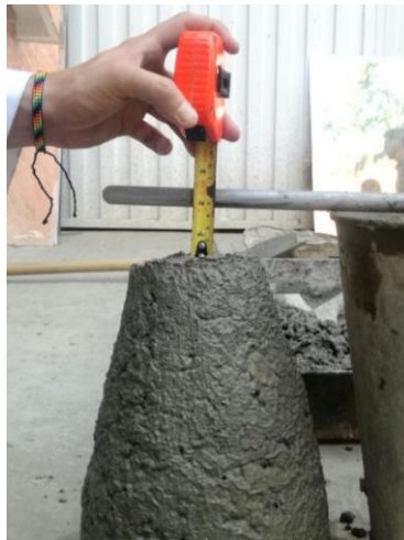
Figura 5. Medición del asentamiento para el CMNR30.
