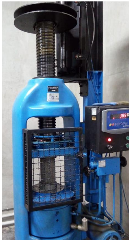
Figura 6. Especimen sometido a la carga axial de compresión.
