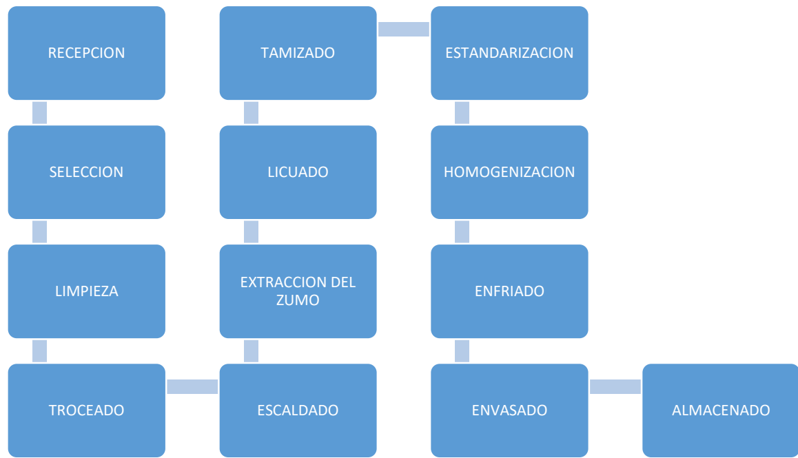
Figura 4. Diagrama de la elaboración del zumo de nopal
