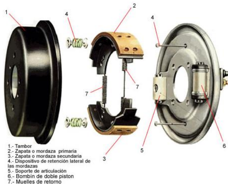
Figura 29. Partes del freno de tambor.
