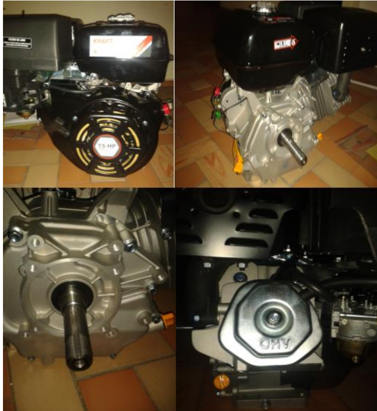
Figura 94. Motor KRAFTTOOLS de 15 HP.
