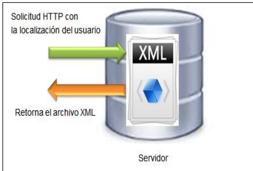
Figura 14. Funcionamiento de un canal estático.
