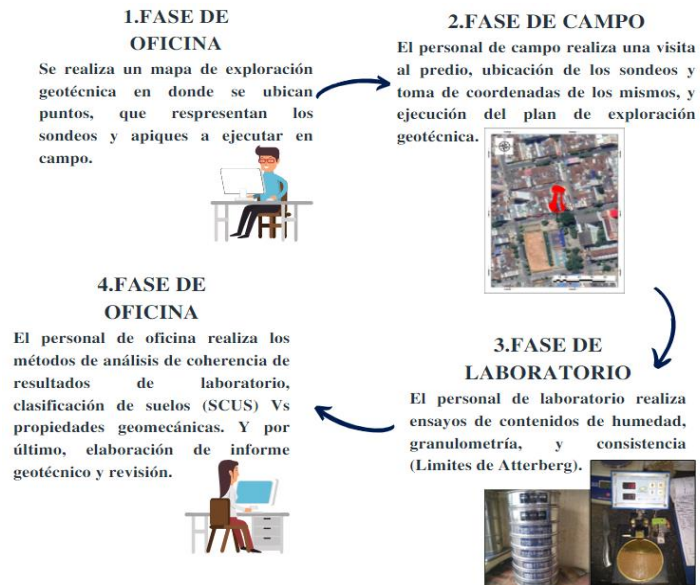
Figura 8. Metodología usada para la exploración geotécnica.
