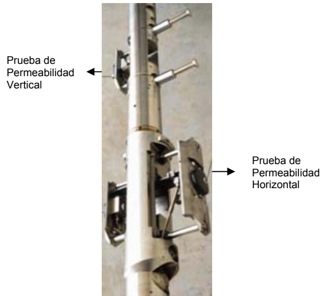
Figura 35. Probador Modular de la Dinámica de la Formación MDT. Tomado de: SCHLUMBERGER, (2002).
