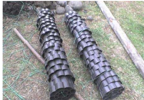
Foto 13. Estructuras para lecho filtrante
