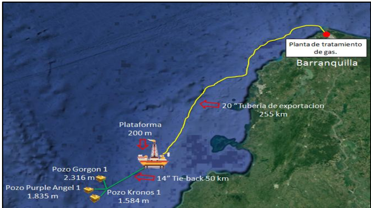
Figura 6. Sistema de producción y transporte de gas de los pozos Gorgon 1, Purple Angel y Kronos 1. Vista espacial de todo el recorrido desde los pozos hasta la planta en tierra mediante la herramienta cartográfica de modelado de datos SIG Google Earth Pro.
