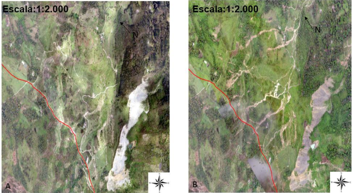
Fuente: E.D Ingeoeotecnia S.A.S A) Detalle de la fotografía con Drone eBee vista en planta flujos Paramito y Sopotá escala 1:2.000, Marzo de 2015. B) Detalle de la fotografía con Drone eBee vista en planta flujos Paramito y Sopotá escala 1:2.000, Junio de 2015.
