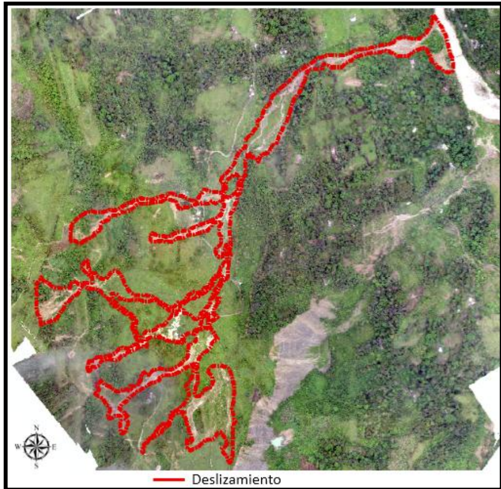
Imagen 34 flujo de lodo y detritos conectados entre sí característicos de la zona de estudio.
