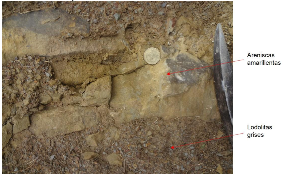
Imagen 12 Arenisca amarillenta de matriz lodosa, y lodolitas fisiles, perteneciente a la Formación Mirador
