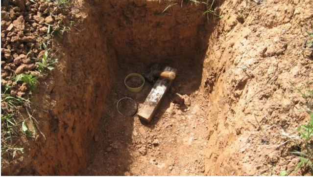
Figura 5. Apique para extracción de muestra ensayo de corte.
