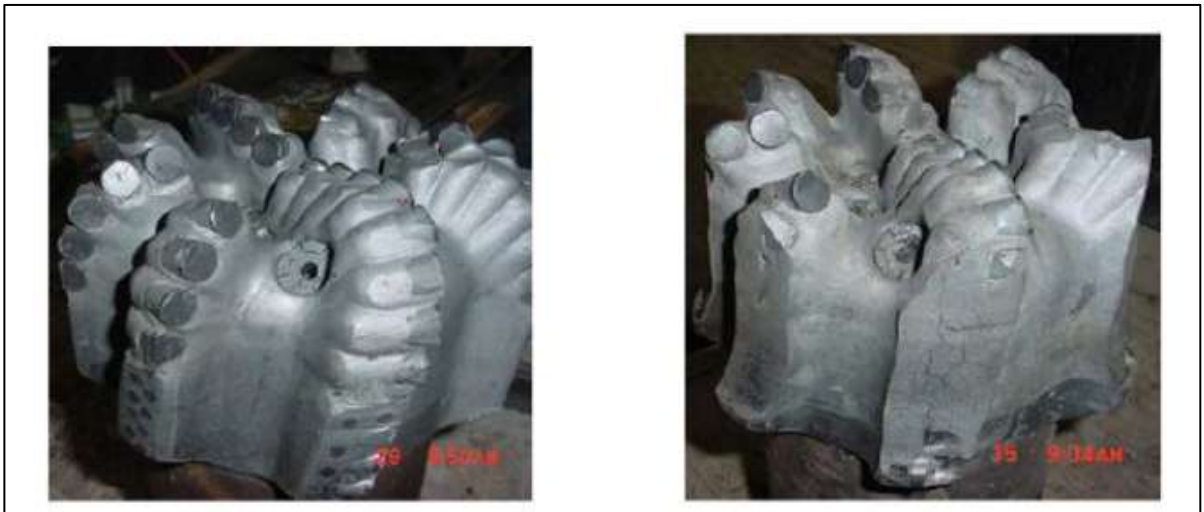
Figura 27. Daños en una broca PDC por vibración
