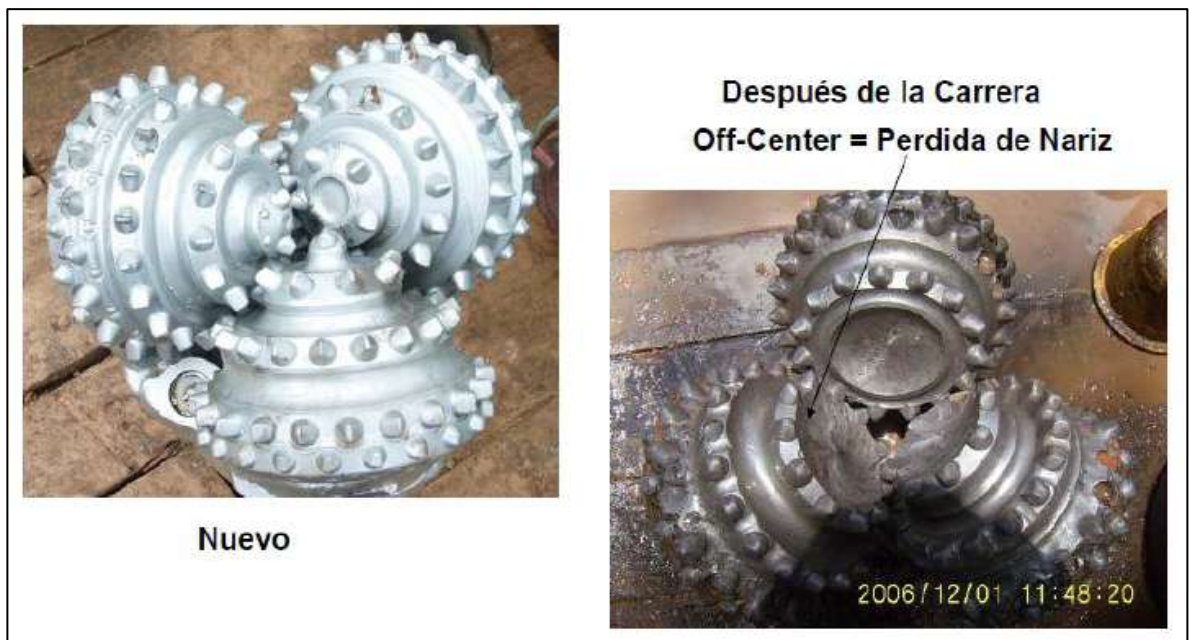
Figura 28. Perdida de la nariz de una broca tricónica por vibraciones
