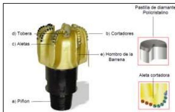
Figura 9. Partes de una broca PDC
