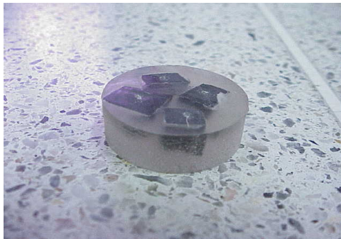
Figura 24 Muestras de shale encapsuladas en la resina de montaje.
