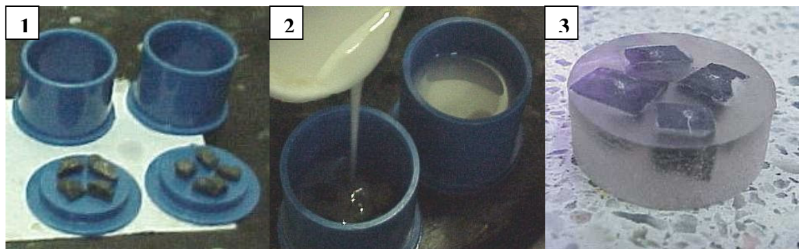
Figura 3. Procedimiento para la elaboración de las probetas para la prueba de indentación.
