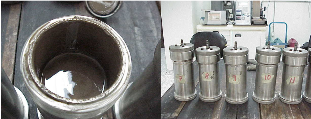
Figura 23 Celdas de envejecimiento que contienen el fluido y los cortes de roca.
