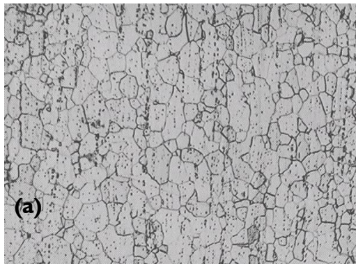
Figura 5. Micrografías ópticas del Acero AISI 430 comercial y el estudiado: (a) Comercial [6], (b) 100x, (c) 1000x y (d) 2000x.
