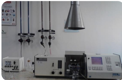
Figura 24. Espectrómetro de absorción atómica. Tomada en el laboratorio del grupo GIMBA (UIS). Sede Guatiguará.
