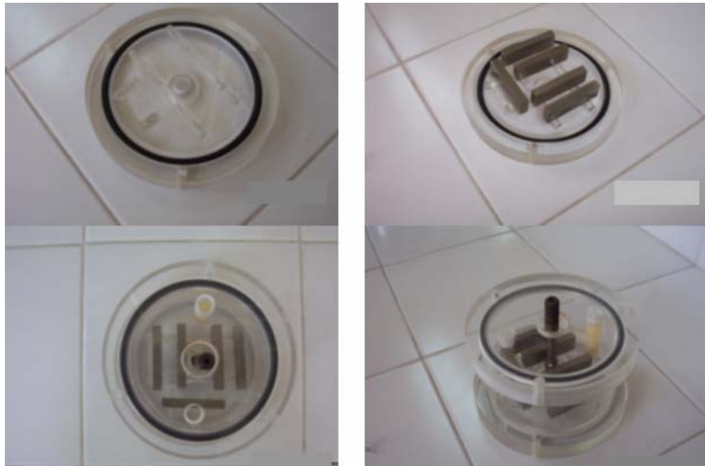
Foto 6. Montaje de las muestras dentro de las celdas
