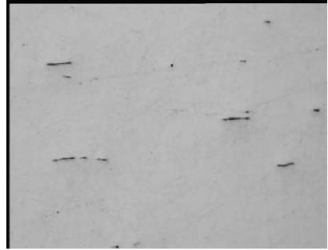
Foto 14. Inclusiones de la muestra M2
