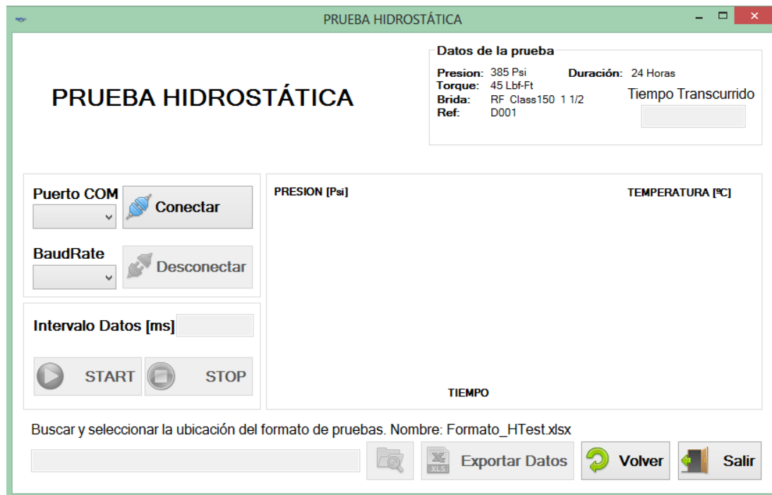
Figura 58. HyTest: Registro de datos
