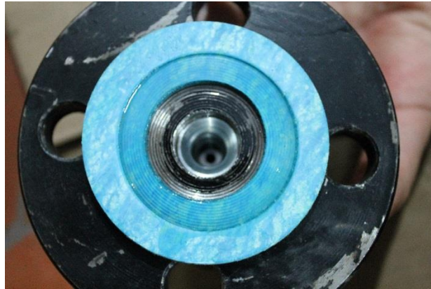
Figura 47. Garlock BlueGard 3000 – Después de la prueba hidrostática
