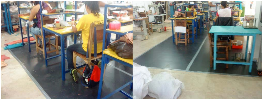
Figura 9. Marcación zona de armado
