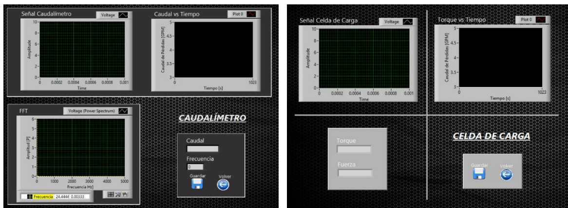
Figura 37. Panel Frontal del Caudalímetro y de la celda de carga
