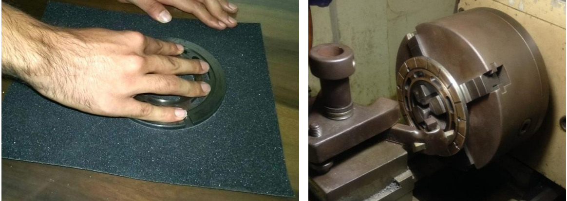
Figura 46. Rectificado y torneado de los platos
