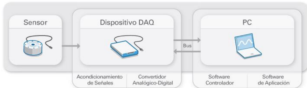
Figura 23. Cadena general de adquisición de datos
