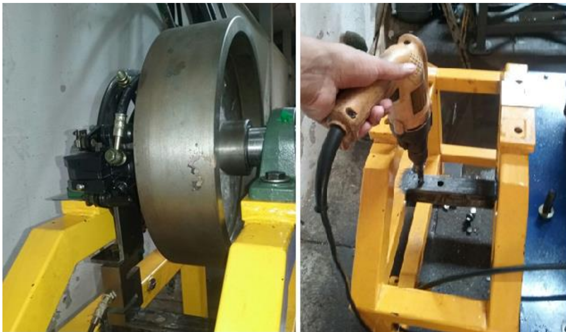
Figura 17. Perforado de elemento que sostiene la celda de carga
