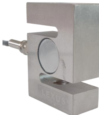
Figura 7. Celda de Carga tipo S marca Lexus 1t
