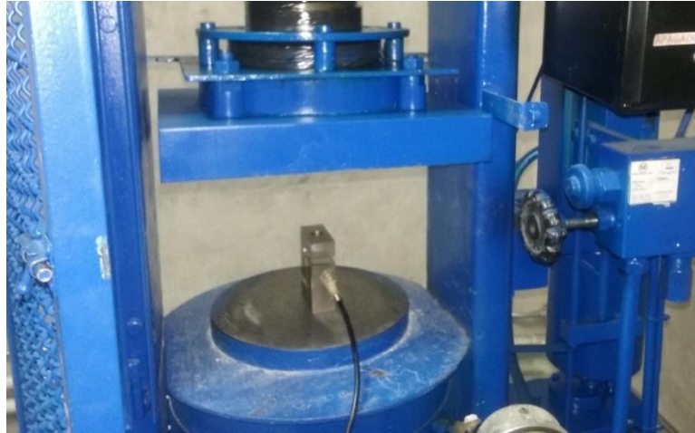
Figura 20. Calibración celda de carga a compresión.
