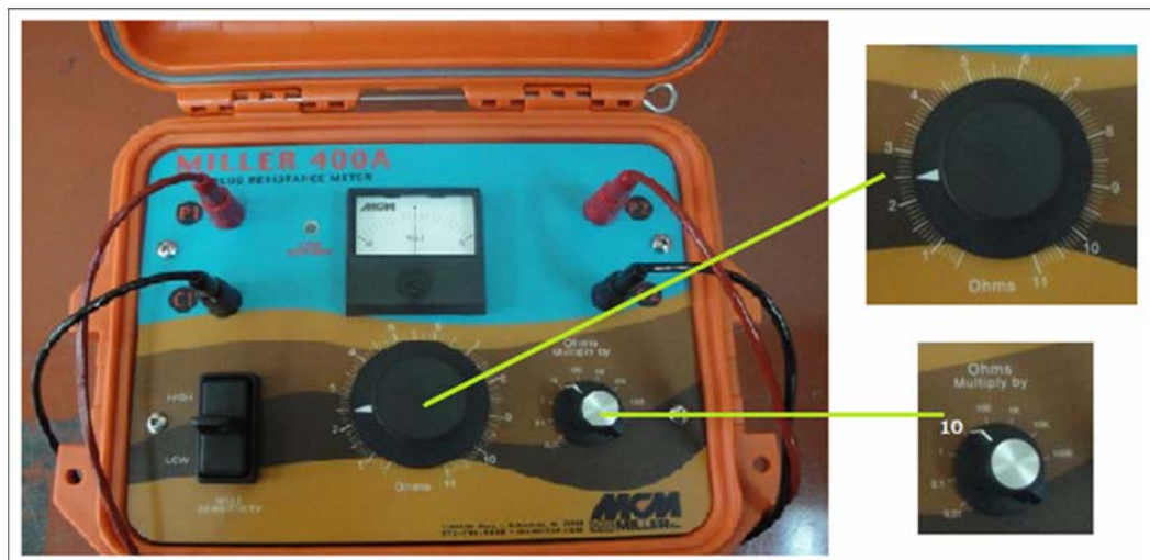
Fotografía 5. Medición de resistividad eléctrica
