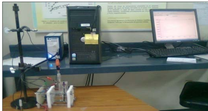
Fotografía 3. Equipos y montaje empleado en la determinación de la densidad de corriente
