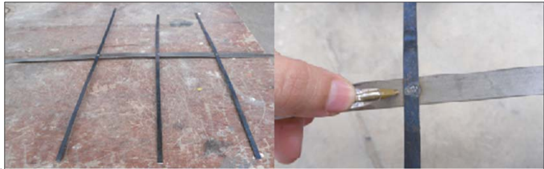
Figura A-3 Ánodos tipo malla MMO, soldada con soldadura por
