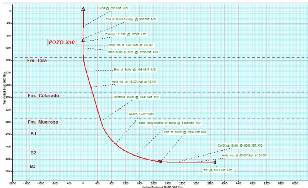
Figura 43. Plan direccional creado por Well Planning para el pozo X10.
