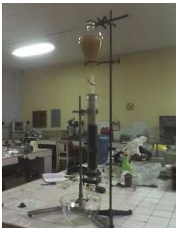
Figura 19. Montaje para la extracción de barbaloina en columna empacada.
