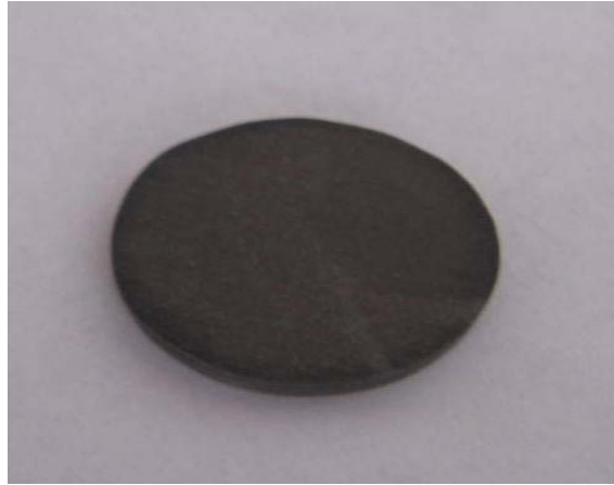
Figura 26. Foto probeta después de electrodepositar Ni
