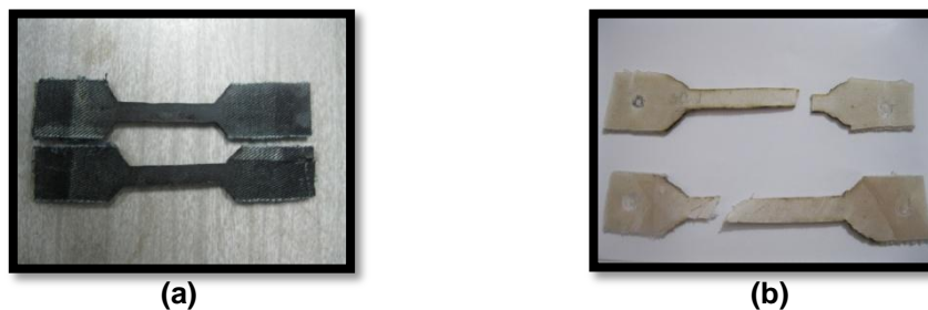
Imagen 6. (a) Probetas de elaboradas con la tela de jean. (b) Probeta con tela natural después del ensayo de tracción.
