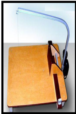
Cortador de alambre caliente regulado por un variac
