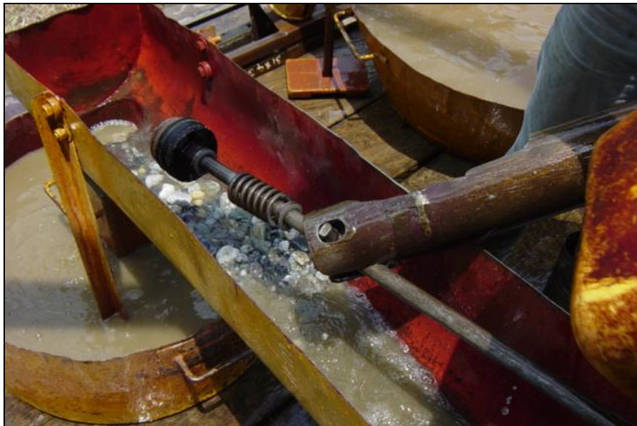
Figura 17. Material obtenido de un bombeo durante la perforación en campo.
