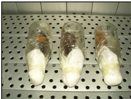
Figura 10. Montaje para las pruebas de fermentación sobre sustrato sólido.
