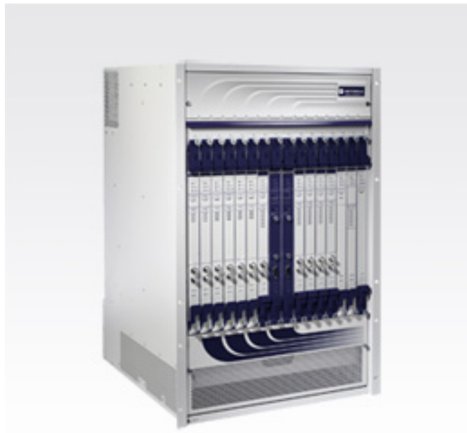
Figura 22. CMTS (Sistema de Terminación de Cable módems). 40
