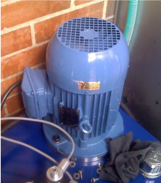
Figura 10. Motor eléctrico unidad hidráulica
