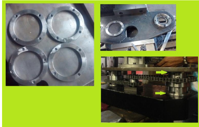
Ilustración 79. Acople arandelas de alineación
