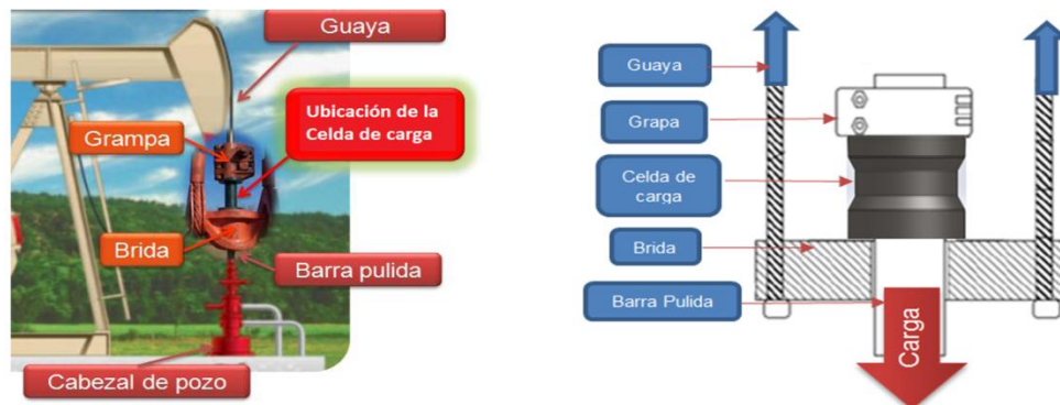
Ilustración 2. Cabezal de pozos petroleros y ubicación celda de carga.
