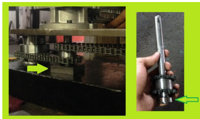
Ilustración 82. Ensamble de rodamiento
