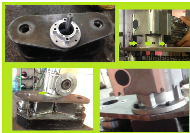
Ilustración 80. Ensamble del moto-reductor
