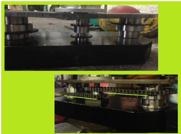
Ilustración 78. Alineación de sprocket
