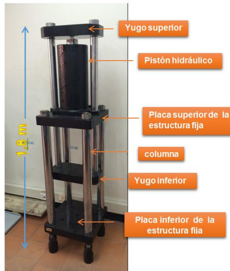
Ilustración 3. Máquina de calibración de fuerza universal de 50.000lbf.
