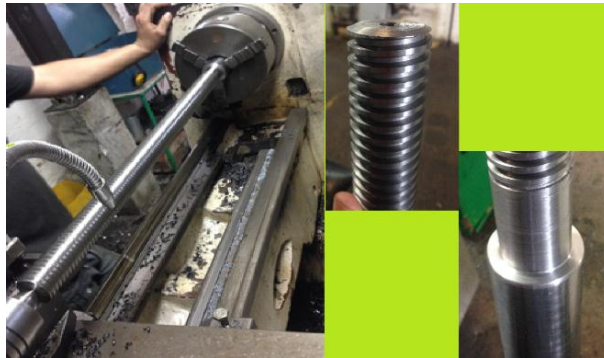
Ilustración 67. Proceso de fabricación barras roscadas
