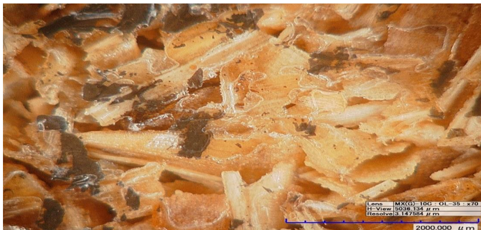
Figura 31. Micrografía (70X) de un aglomerado con restos de radiografía (desmoldante).
