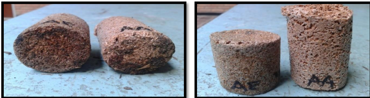
Figura 33. Aglomerados de aceite esencial (AE) y acetato de amilo (AA) después de 30 días de sometimiento a la intemperie.
