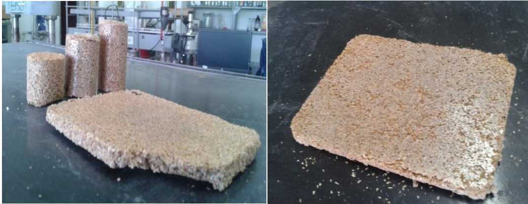
Figura 26. Algunas probetas de aglomerados usando diferentes moldes durante el conformado.
