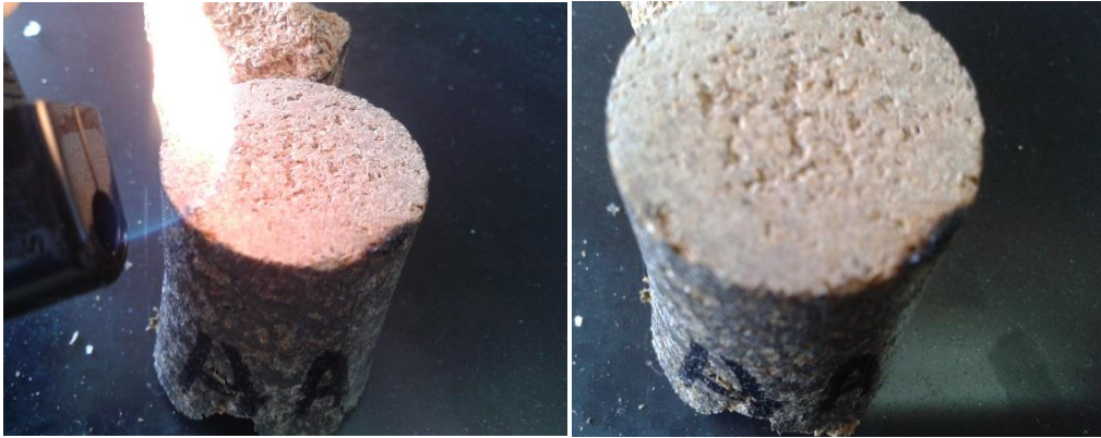
Figura 38. Prueba de inflamación para un aglomerado a base de emulsión de acetato de amilo.
