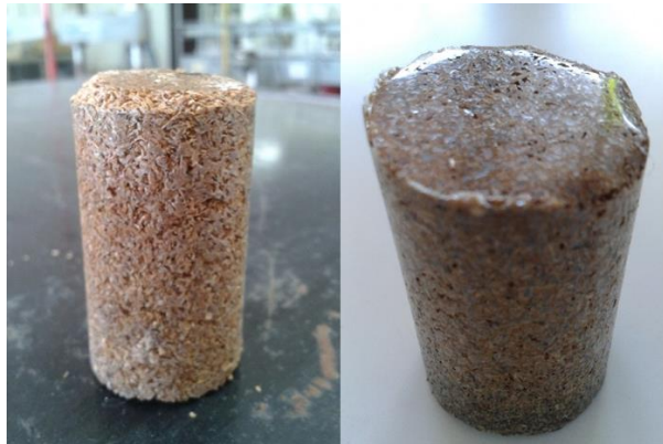
Figura 25. Comparación entre un aglomerado con proporción 1:1 de emulsión/cascarilla y otro aglomerado con proporción 3:1.
