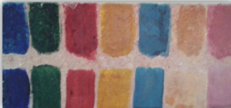
Figura 45. Aplicación de pinturas sobre ladrillo. En la parte superior se usaron las pinturas con emulsión de aceite esencial y en la parte inferior las pinturas a base de acetato de amilo.
