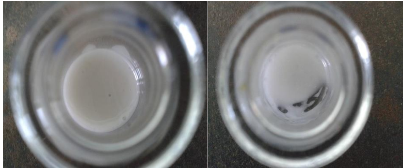
Figura 23. Vista de una emulsión normal y de la emulsión AA1 después de agregar agua.
