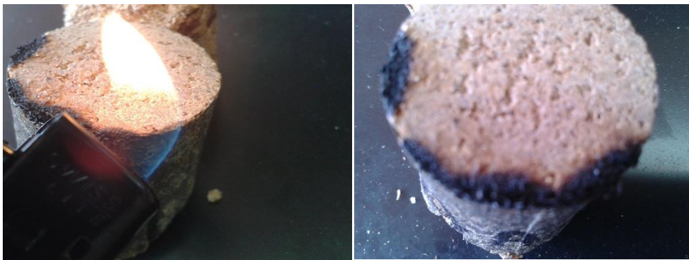
Figura 39. Prueba de inflamación para un aglomerado a base de emulsión de aceite esencial de naranja.
