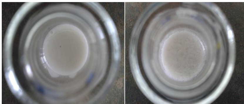
Figura 24. Vista de una emulsión normal y de la emulsión AE1 después de agregar agua.
