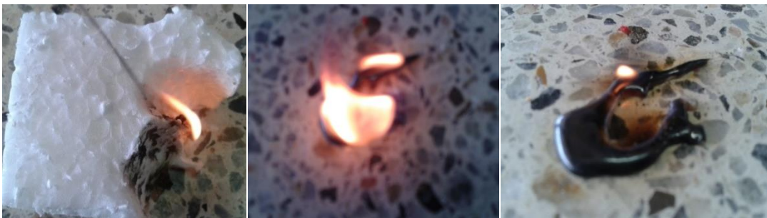
Figura 34. Secuencia de inflamación del EPS.
