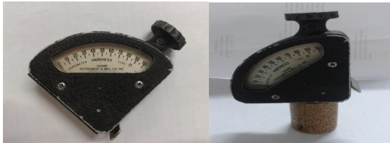
Figura 14. Durómetro Shore D y cálculo de dureza en una probeta usando el durómetro.
