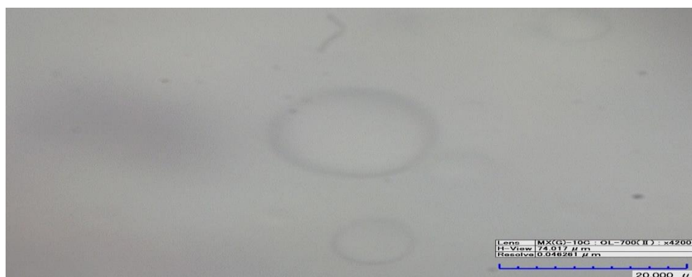
Figura 19. Micrografía (4200X) donde se observa una de las micelas de la emulsión AA1.
