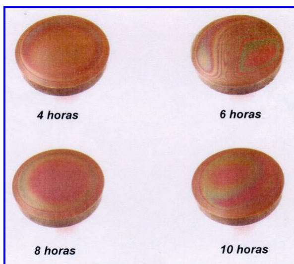
Foto 16 Probetas polimerizadas con diferentes tiempos de tratamiento.
