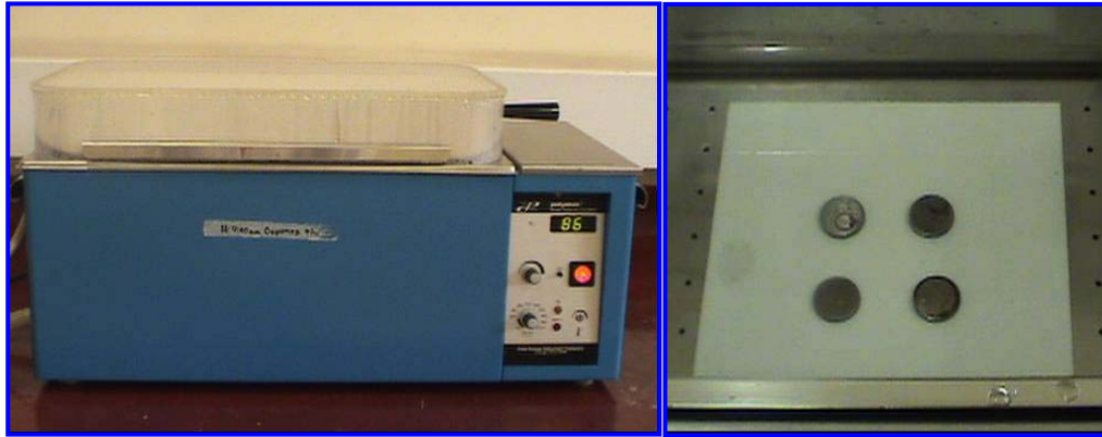
Foto 9 (a) Baño termostatado. (b) Probetas en inmersión.
