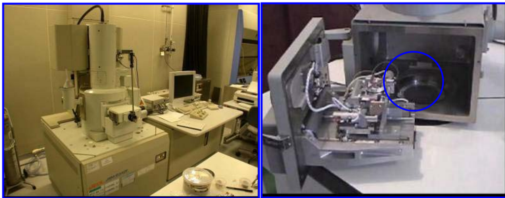
Fotografía 12. (a) Aspecto general del microscopio electrónico de barrido. (b) Interior del microscopio electrónico, el círculo muestra el lugar donde se ubican las muestras a analizar.
