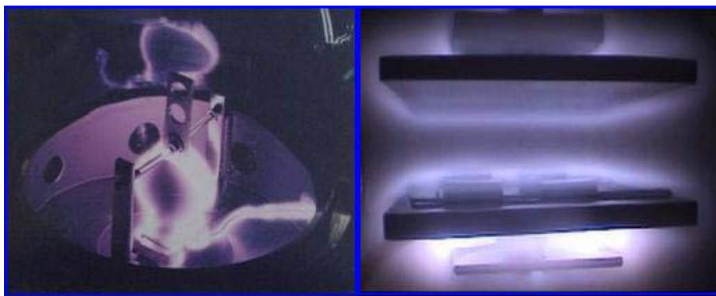
Foto 13 Descarga en argón. (a) Reactor-UIS (b) Reactor CIC.
