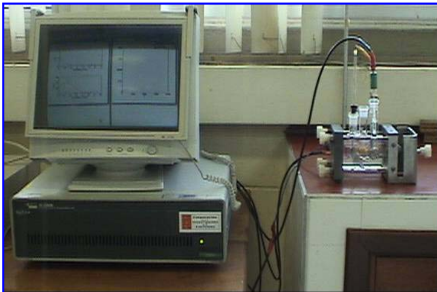
Foto 10 Montaje experimental de la celda electroquímica.
