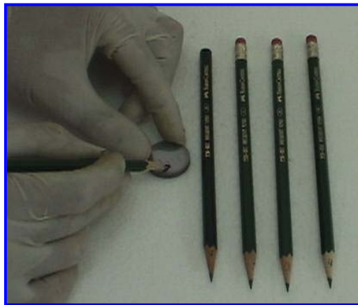
Foto 7 Probetas sometidas a la prueba del rayado.
