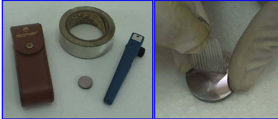
Foto 8 Probetas sometidas a la prueba de adherencia con cinta.
