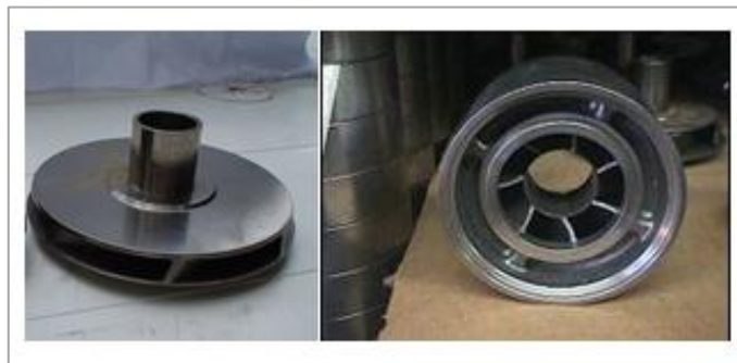
Figura 5. Impulsor y Difusor de una etapa para Bombas Electrosumergibles
