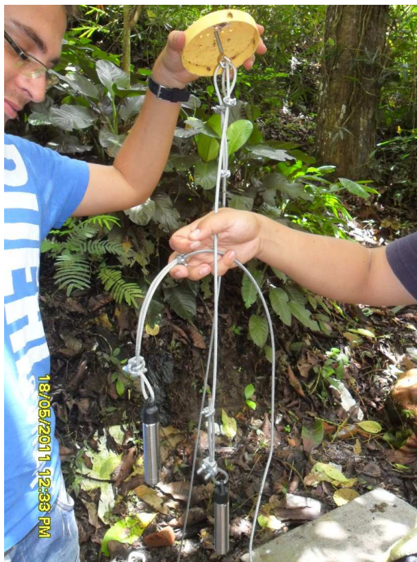
Figura 12. Sujeción de los equipos a la guaya recubierta.
