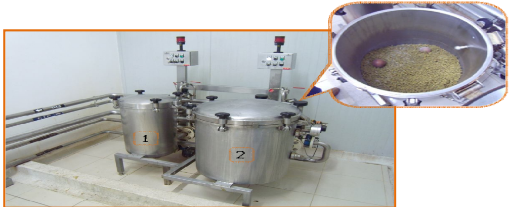
Figura 2. Dosificadores de lúpulo. (1) Dosificación de extracto de lúpulo. (2) Dosificación de pellets de lúpulo.
