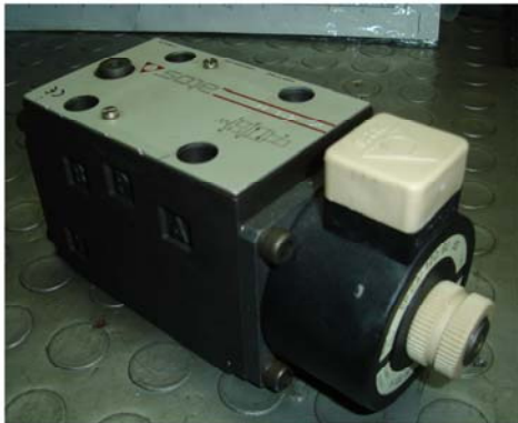
Figura 6.1. Válvula direccional CETOP 5 de dos posiciones cuatro vías centro tándem accionada por solenoide marca ATOS.
