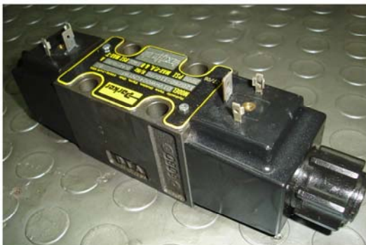
Figura 6.2. Válvula direccional CETOP 3 de tres posiciones cuatro vías centro punto flotante accionada por solenoide marca PARKER.
