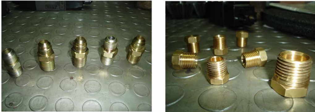
Figura 6.4. Racores \frac{1}{2} in NPT a \frac{3}{4} in y tapones DE \frac{1}{4} Y \frac{1}{2} NPT
