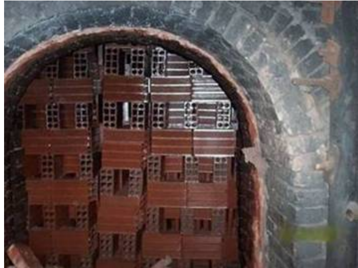
Figura 23. Enfriamiento del material en el proceso de Cocción.
