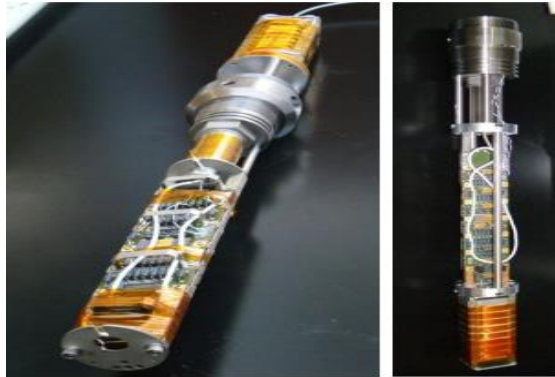
Figura 2. Componentes internos sensor de fondo
