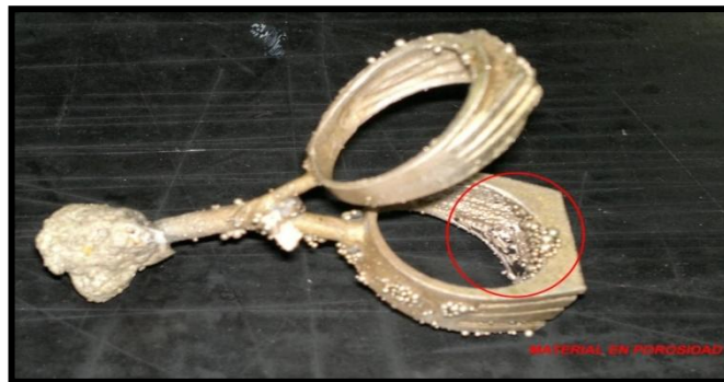
Figura 28. Acabado Superficial de la pieza colada
