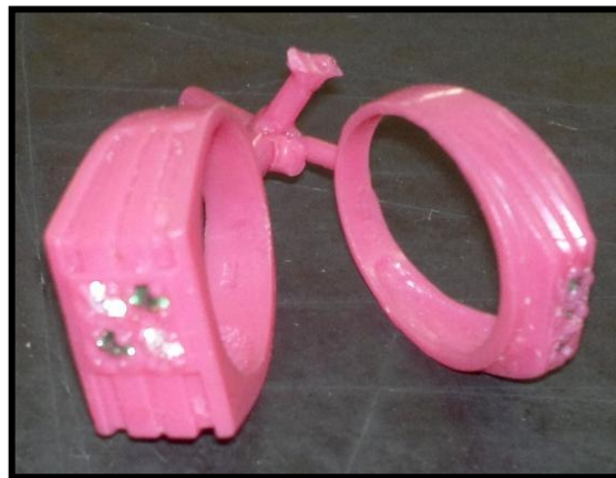
Figura 11. Esmeraldas pre-engastadas en el modelo en cera
