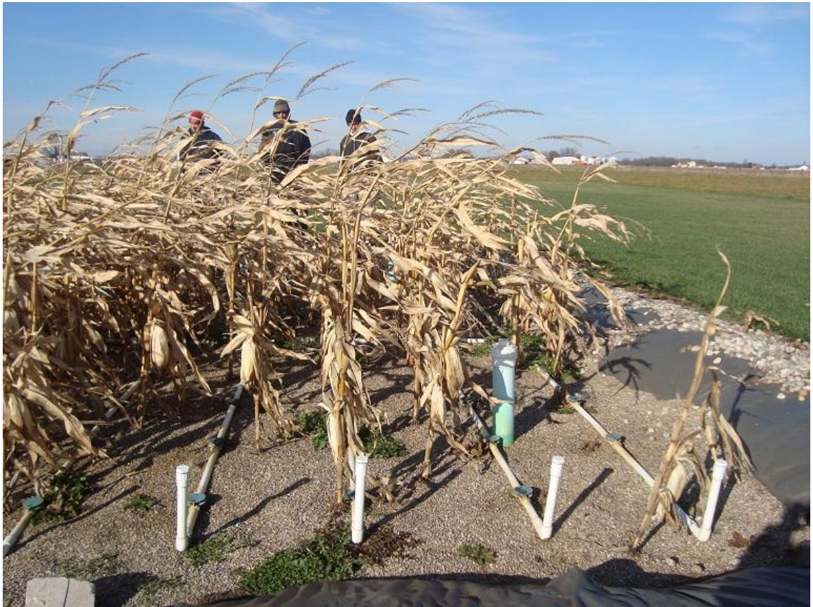
Figura 7. HCFSSV con un arreglo de tuberías perforadas con juntas rotatorias para distribución de flujo en Middlebury, Indiana. 2011
