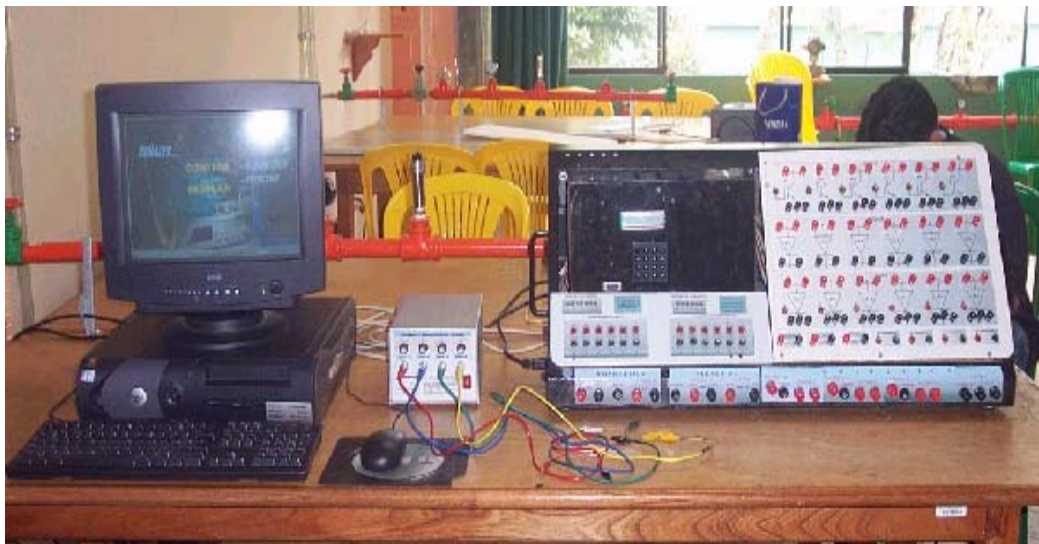
Figura 1. Fotografía del equipo convertor estático de potencia
