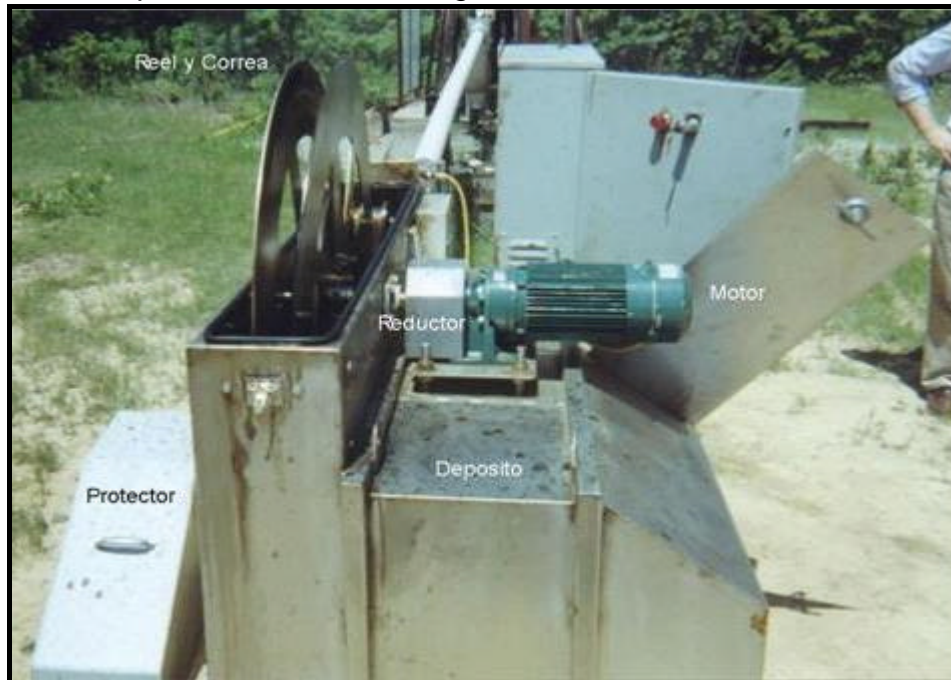
Figura 22. Aplicación de la tecnología BORS Lift. Parte 1
