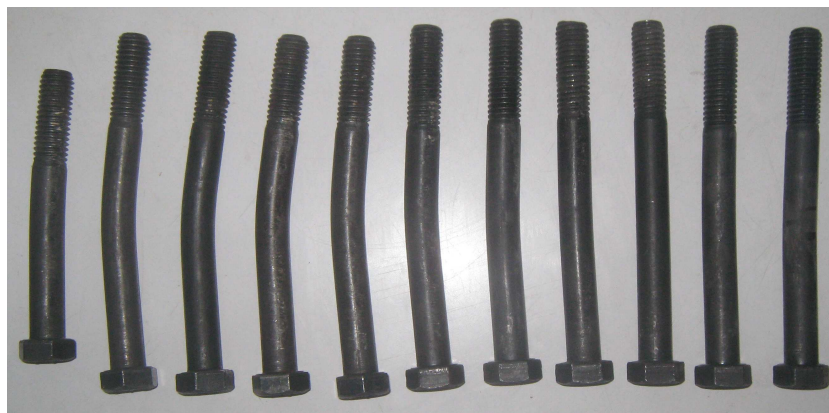
Figura 61. Forma de fallada de pernos de 1/2" en la conexión tipo 3A a tensión
