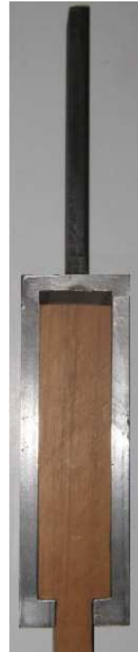
Figura 35. Acople para ensayos a tensión paralela a las fibras
