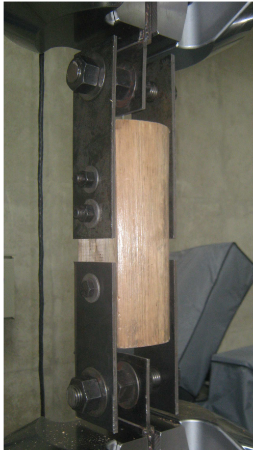
Figura 58. Ensayo probeta a tensión de la conexión tipo 3A con un perno de 1/2"
