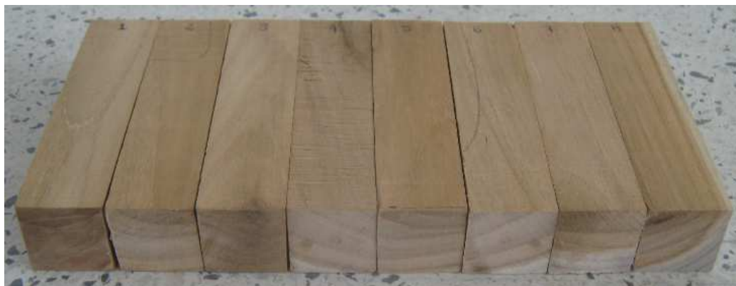
Figura 28. Muestras para ensayo a compresión paralela a las fibras según ASTM D143-09
