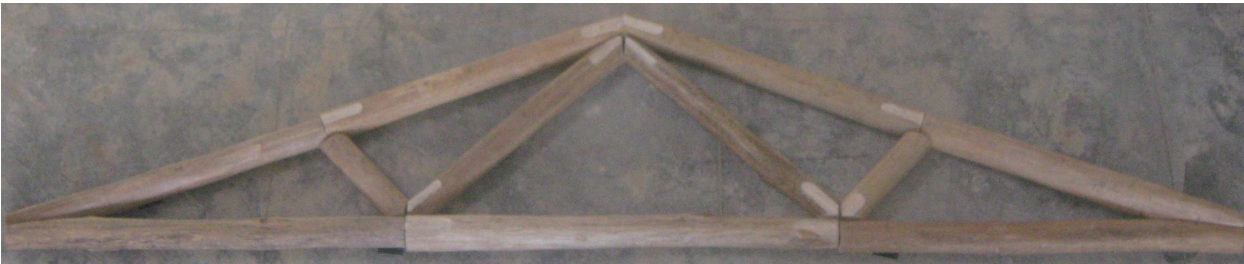
Figura 12. Cercha tipo W con madera teca rolliza sin ensamblar
