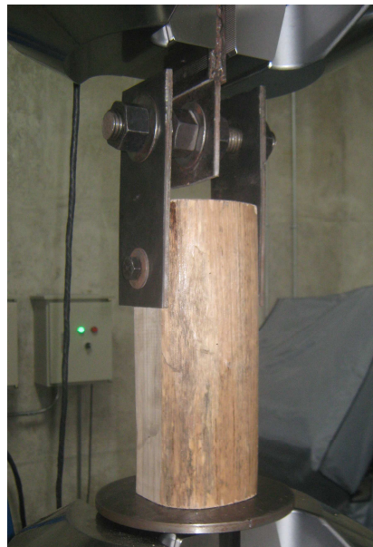
Figura 49. Ensayo probeta a compresión de la conexión tipo 3A con un perno de 1/2"
