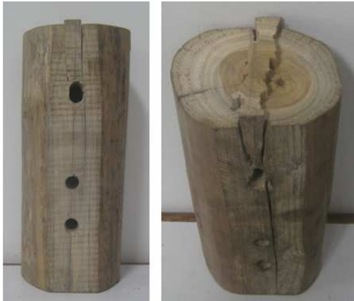
Figura 59. Forma de fallada a tensión de la conexión tipo 3A con un perno de 1/2"
