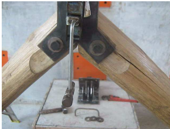
Figura 79. Modo de falla del nodo B de la cercha triangular
