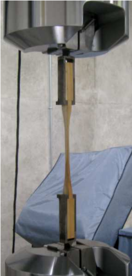
Figura 34. Ensayo tensión paralela a las fibras de muestra según ASTM D143-09
