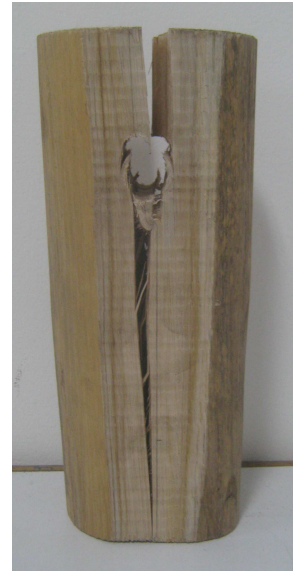
Figura 51. Corte generado posterior al aplastamiento de un perno de 1/2" en la conexión tipo 3A a compresión
