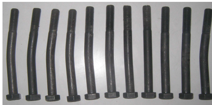
Figura 52. Forma de fallada de pernos de 1/2" en la conexión tipo 3A a tensión
