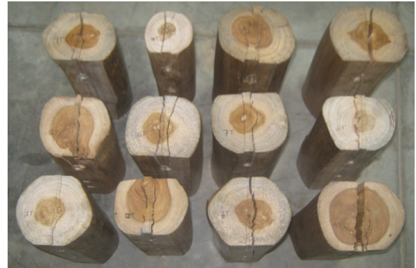
Figura 60. Probetas falladas a tensión de la conexión tipo 3A con un perno de 1/2"
