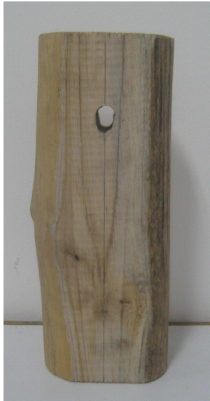
Figura 50. Aplastamiento producido por de un perno de 1/2" en la conexión tipo 3A a compresión
