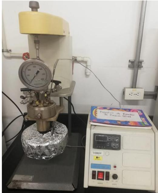
La reacción de solvólisis se realizó en un reactor batch Parr 4842.
