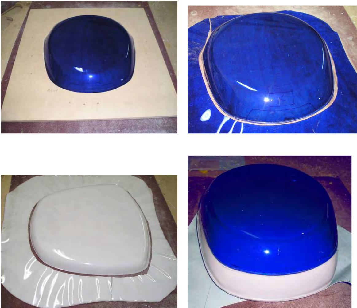
Figura 116. Piezas termoformadas.
