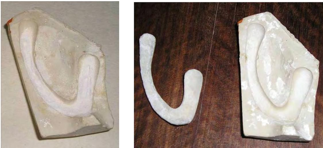
Figura 117. Formación de capas con acrílico auto curable
