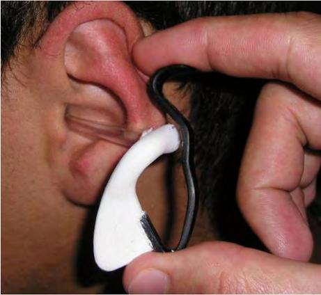
Figura 84. Colocación de porta termistor (TEMP CAE)
