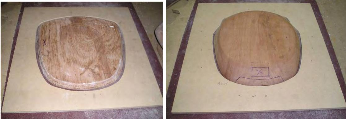
Figura 115. Moldes para la fabricación de las piezas por apisonado.
