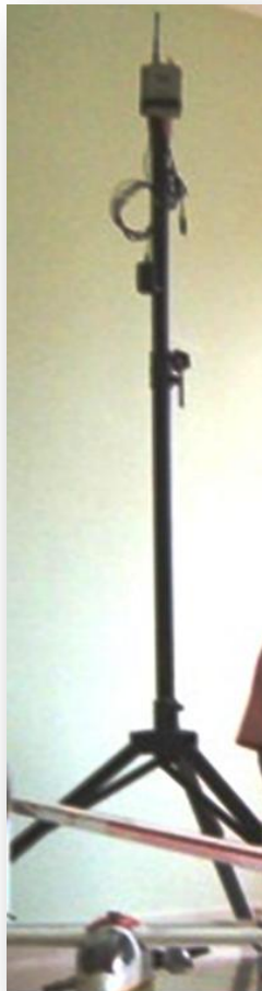
Figura 108. Trípode para antena y amplificador.
