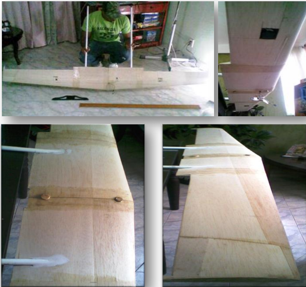
Figura 89. Proceso de unión y adecuación de las alas.
