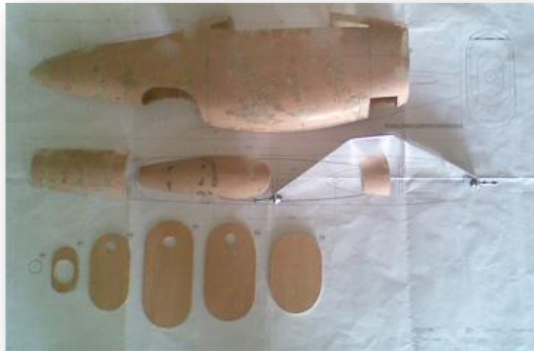
Figura 84. Proceso de fundido en fibra y acabado del fuselaje.
