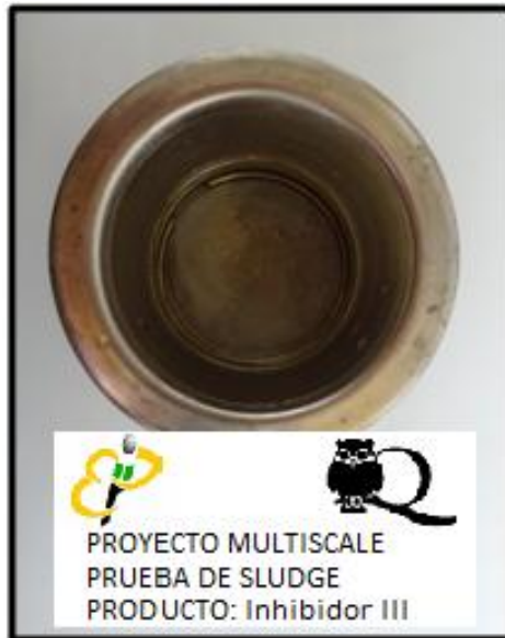
Figura 32. Prueba de Sludge con el inhibidor III
