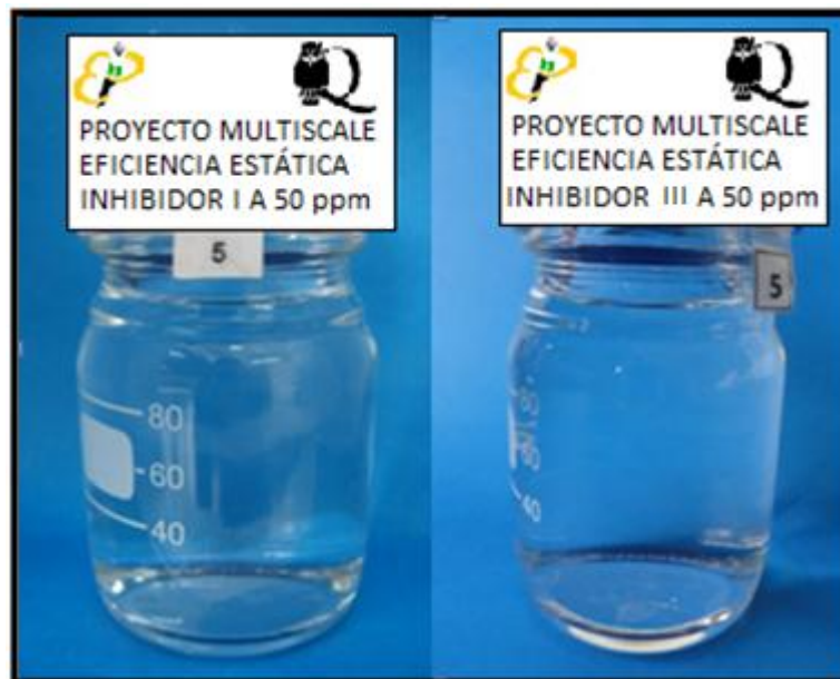
Figura 26. Prueba de eficiencia estática a 50 ppm del inhibidor I y III.
