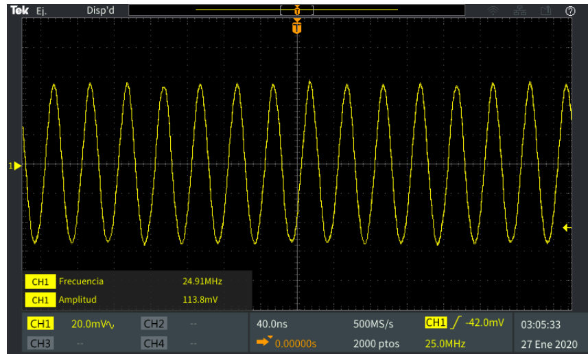
Figura 43: Respuesta de voltaje del LNA. Señal de entrada sinusoidal de amplitud 1 mV.
