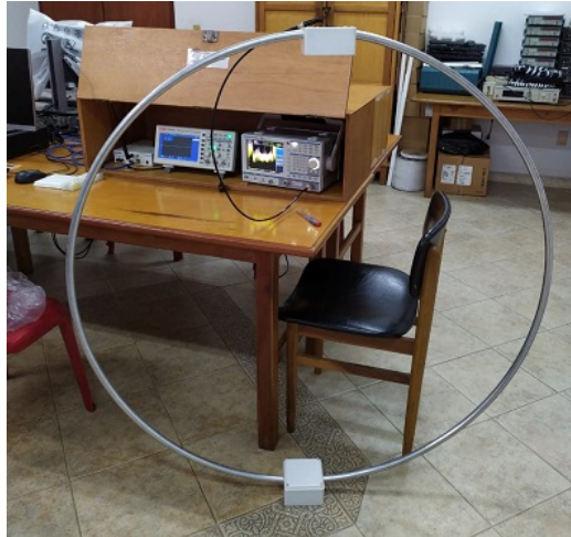
Figura 40: Pruebas de laboratorio para la antena SALLA (sencilla), laboratorio de comunicaciones E3T.
