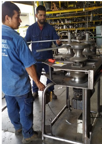
Figura 29: Doblado de tubo antena SALLA.
