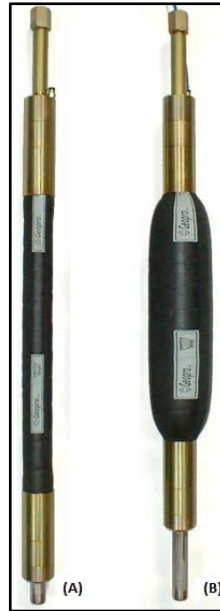
Figura 21. Obturador simple: (A) En reposo, (B) Inflado.
